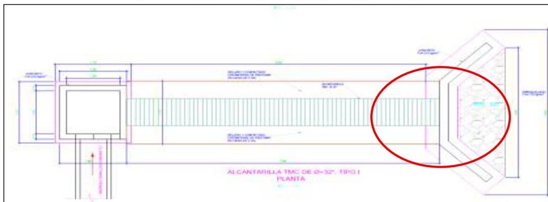
IMAGEN N° 7 DETALLE DE TUBERIA METALICA CORRUGADA
